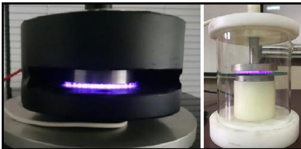
شکل ۴- دو نمونه از مولدهای پلاسمای سرد تخلیه سد دی الکتریک (DBD) ساخته شده توسط نویسندگان (Mazandarani, Abolfazl et al., 2020).
